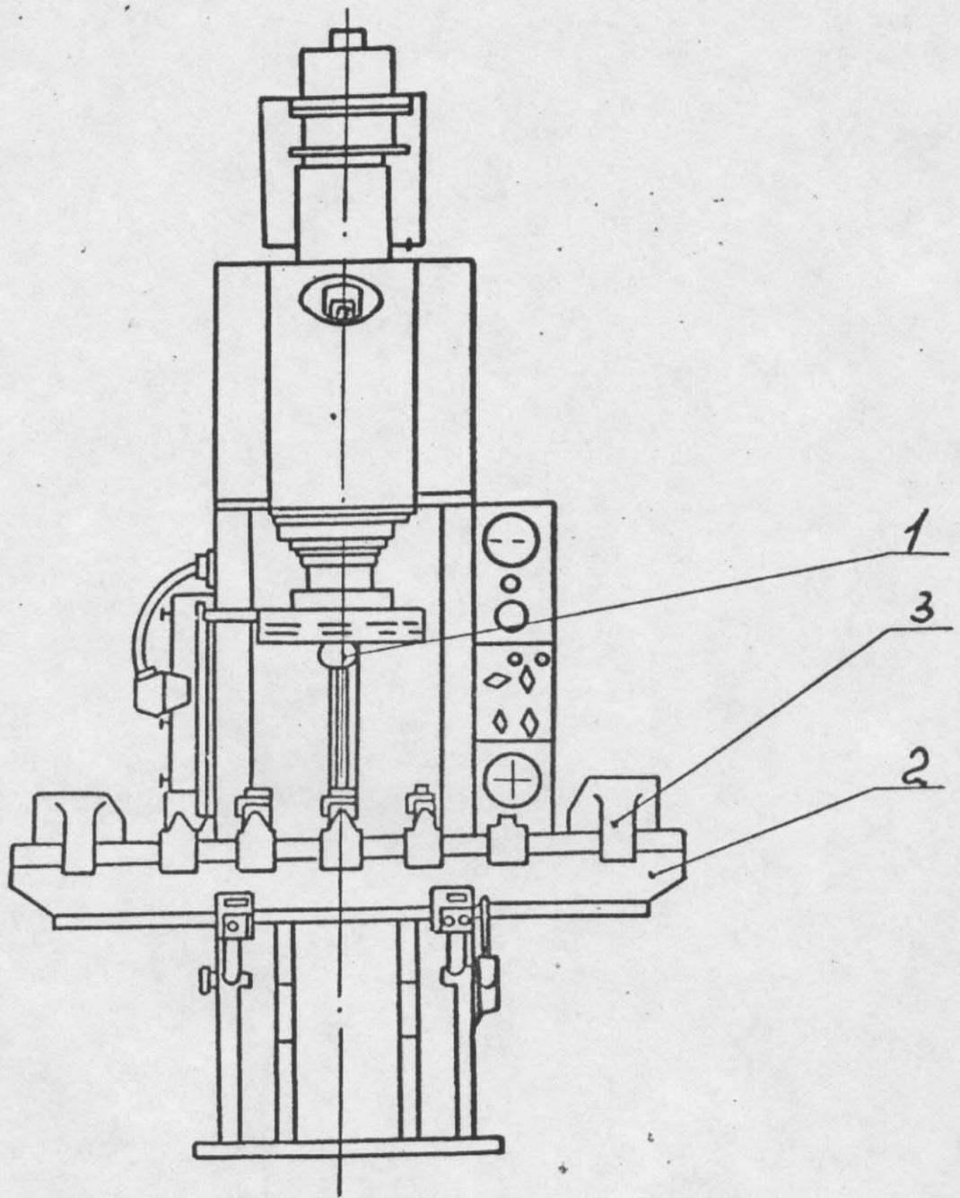
Рис 1. Пресс ПБ332Б с бойком, столом, правильной оснасткой.
