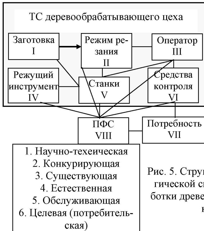
Рис. 5. Структура технологической системы обработки древесины на станках
