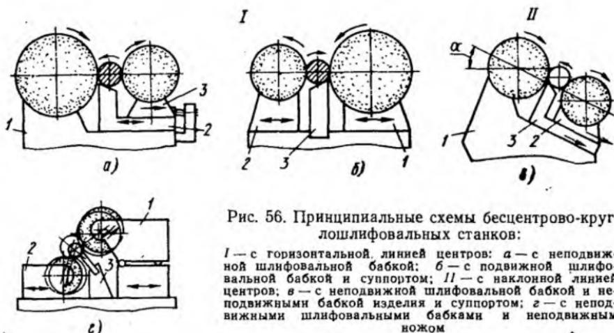
Рис. 56. Принципиальные схемы бесцентрово-круглошлифовальных станков:
